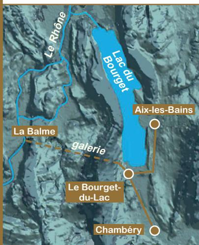
Détail des conduites reliant les stations d'épuration d'Aix-les-Bains et Chambéry à l'entrée de la galerie au Bourget-du-Lac, d'où part le tunnel gravitaire sous le Mont du Chat
